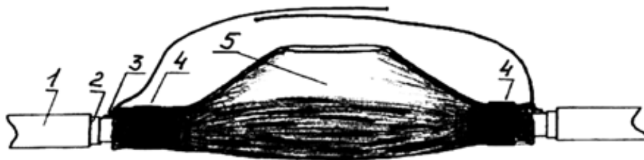
Рис. 4. Пакет из пластиковой плёнки (обёртки) перед заливкой геля 8882: 1 – алюминиевая оболочка; 2 – ленты кабельной бумаги; 3 – контрольная жила; 4 – бандаж из липкой ПВХ ленты; 5 – пакет из обёртки.
