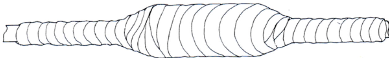
Рис. 14. Муфта МСБ-А(у)б, обмотанная влагоотверждаемым бинтом «Армопласт», который должен перекрывать наружную ТУТ не менее чем на 30 мм по обе стороны от её концов.
