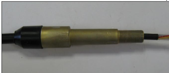
**11** Ввести ОК вместе с собранным штуцером в патрубок оголовника. Надвинуть на сердечник ОК шайбу и гайку и с их помощью закрепить штуцер специальным ключом S=24 мм. Надвинуть на штуцер кронштейн, навернуть гайку и закрепить ее специальным ключом S=24 мм.
