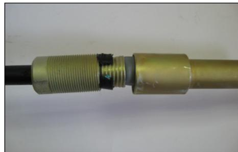
**6.2** Надвинуть конус на внутреннюю оболочку ОК до упора в лепестки сталеполиэтиленовой оболочки.
