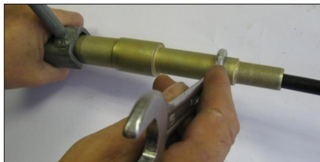
**9** Обрезать внутреннюю оболочку ОК на расстоянии 10 мм от торца штуцера и удалить ее до конца ОК. Обрезать скрепляющие ленты (нити) сердечника на расстоянии 10 мм от торца внутренней оболочки ОК.
