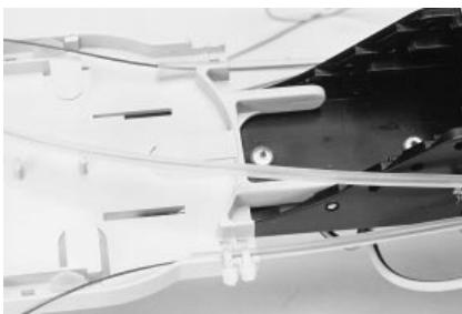
7.1.2 Осторожно отрежьте переходные трубыки по отметке и прикрепите их к лотку двумя поясками. Переходная трубка не должна касаться волокон, уложенных в лотке.
