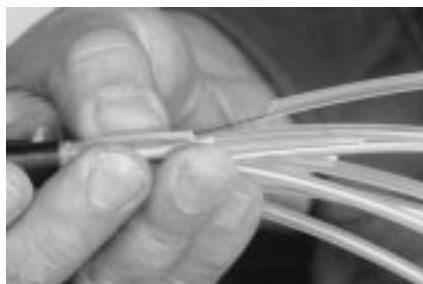
**5.3** На расстоянии 35 мм от среза оболочки кабеля надрежьте и удалите защитные трубы с волокнами. Очистите от гидрофоба пучок волокон. Выберите переходную трубку, которая подходит по диаметру к защитной трубке. Наденьте переходную трубку на волокна и защитную трубку.
