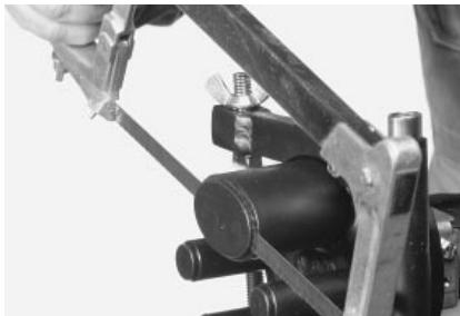
**4.2** Установите муфту FOSC в держатель FOSC-STAND и откройте овальный кабельный ввод срезав с помощью ножовки наконечник ввода. Обработайте внутренний край открытого ввода наждачной полоской.
