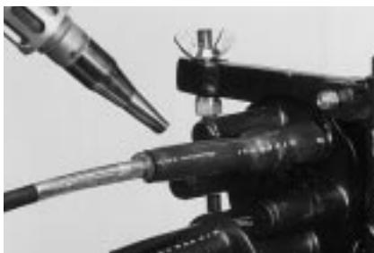
**11.11** Продолжайте усаживать трубку в сторону кабеля. Нагревайте до тех пор, пока трубка не усадится на кабели и зеленая термоиндикаторная краска не станет черной. Кольцо красного клея должно быть видимым на кабеле и на крае трубы.
