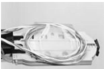
**15.2** Поместите неиспользуемые защитные трубы в рукав для хранения защитных трубок. Используйте пояски-стяжки для закрепления рукава.
